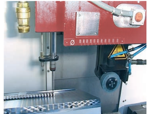
Messtaster , in den Arbeitsraum einfahrbar, bis 2 ½ Achsen und einer Messgenauigkeit von +/- 1µm, Schleifeinrichtung für kleine Schleifscheiben (Ø50...100)
