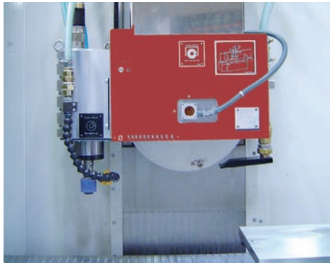
Vertikal-Zusatzspindel für universellen Einsatz im Werkzeugbau, Antriebsleistung bis 6 kW, Drehzahl bis 90.000 min -1
