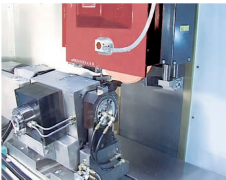
Mehrseitenbearbeitung von Kompressorschaukel
