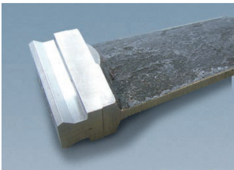
Mehrseitenbearbeitung von Kompressorschaukel
